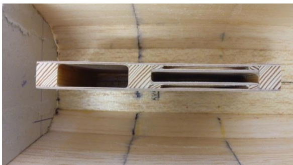
Bild 29 und 30: Einbau der Mast/Kieltasche
