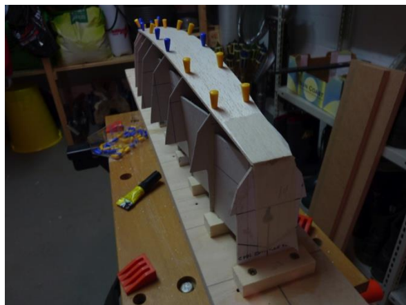
Bild 12 und 13: Die auf dem Spantgerüst fixierte Bodenplanke.
