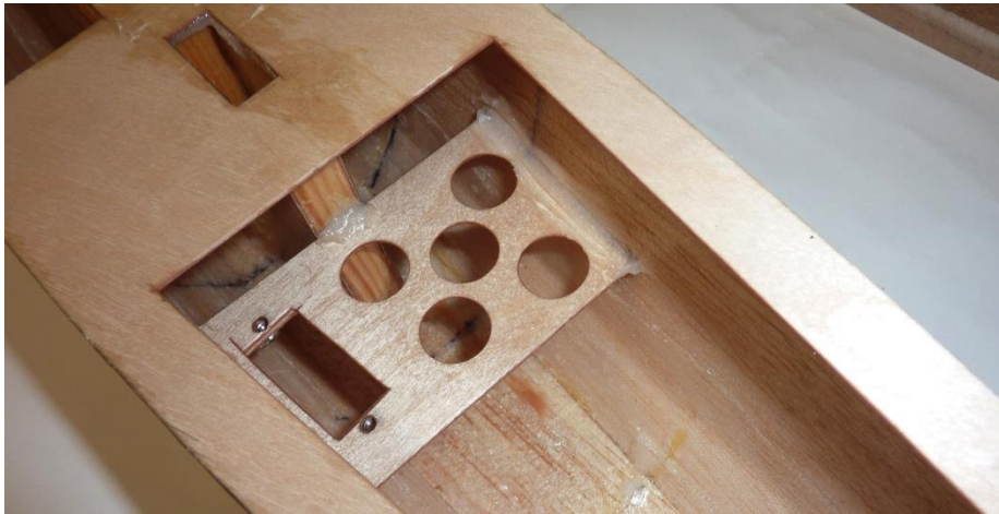
Bild 31: Einbau Segelverstellservo
