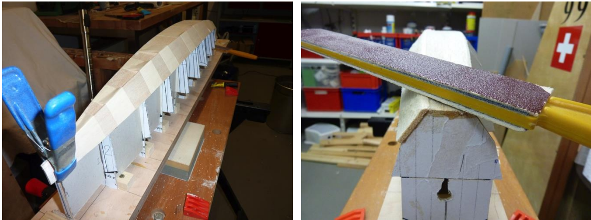
Bild 15 und 16: Anpassen der folgenden Planken.
