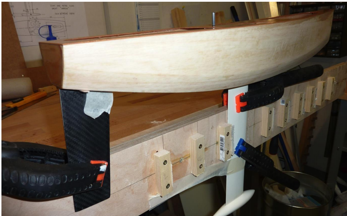
Bild 38 und 39: Montage des Ruderkokers.
