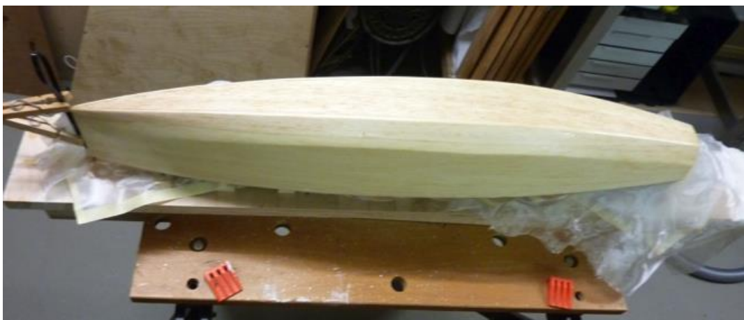
Bild 21 und 22: Der fertig mit Glasgewebe überzogene Rumpf.
