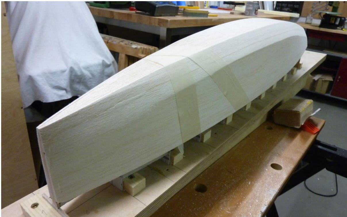
Bild 17: Rumpf mit noch nicht beschnittener Deckskante.
