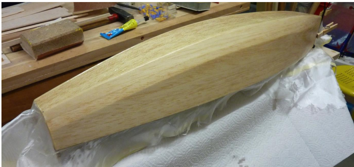
Bild 20: Rumpf mit Glasgewebe überzogen.
