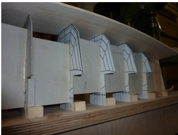
Bild 7, 8 und 9: Übertragen der Spanten- Eckpunkte auf die Bodenplanke
