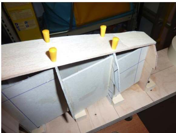
Bild 12 und 13: Die auf dem Spantgerüst fixierte Bodenplanke.
