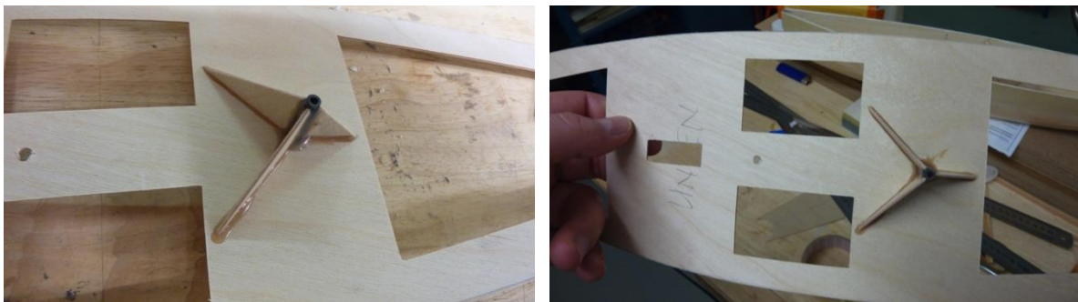
Bild 36 und 37: Carbon Röhrchen mit seitlichen Abstützungen.
