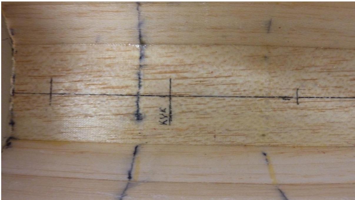
Bild 26: Kielposition markieren
