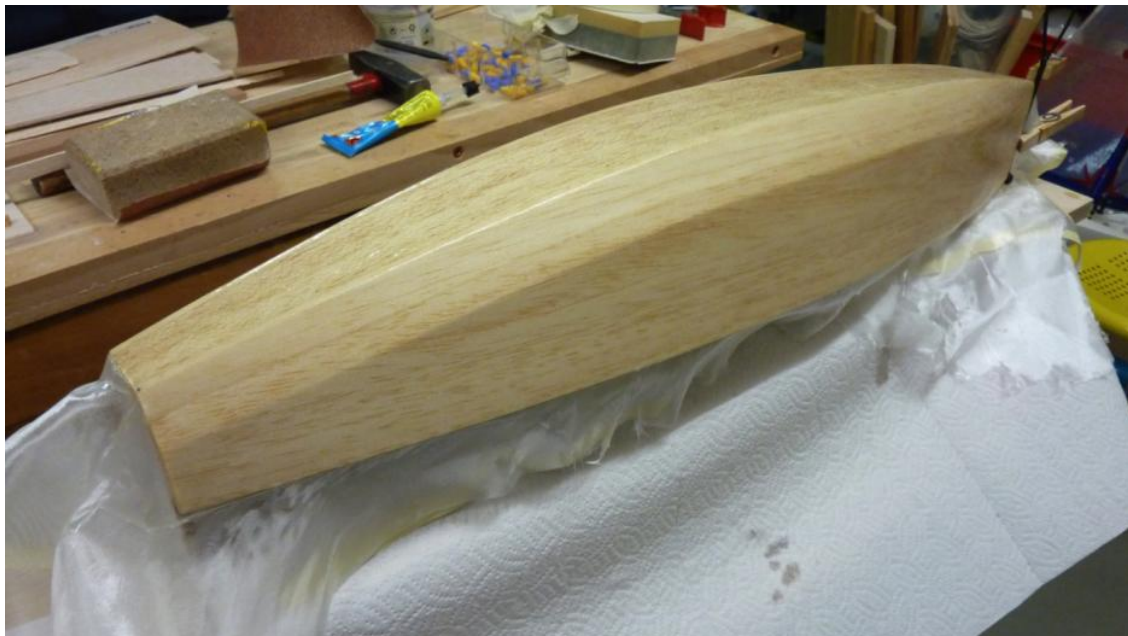
Bild 20: Rumpf mit Glasgewebe überzogen.
