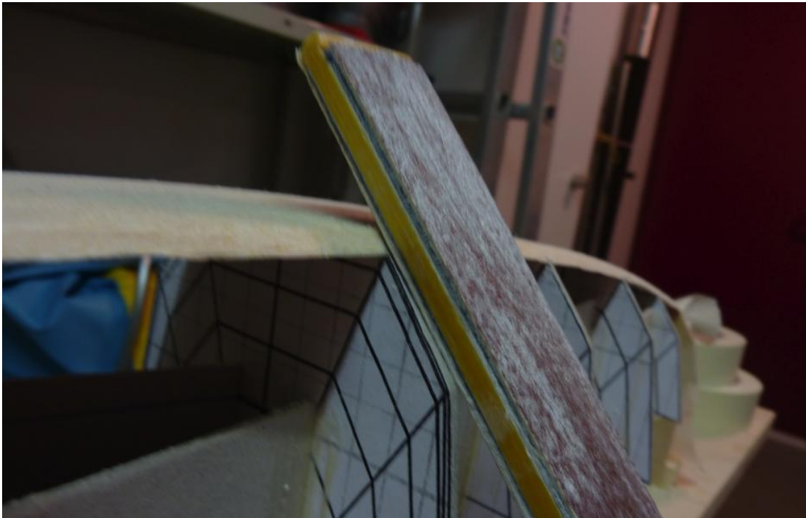
Bild 14: Kantenschleifen.
