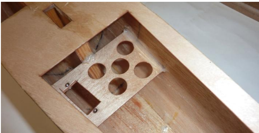
Bild 31: Einbau Segelverstellservo
