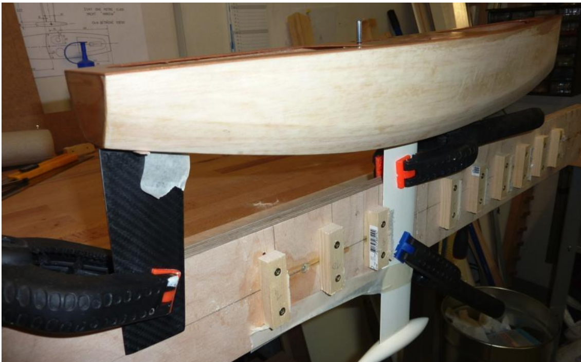
Bild 38 und 39: Montage des Ruderkokers.
