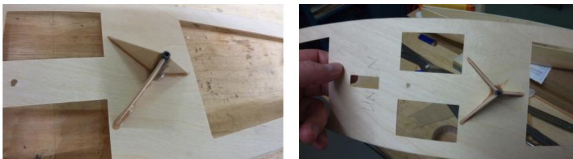
Bild 36 und 37: Carbonröhrchen mit seitlichen Abstützungen.
