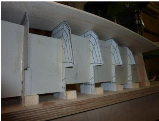
Bild 7, 8 und 9: Übertragen der Spanteneckpunkte auf die Bodenplanke
