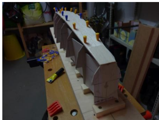
Bild 12 und 13: Die auf dem Spantgerüst fixierte Bodenplanke.
