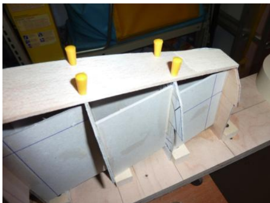
Bild 12 und 13: Die auf dem Spantgerüst fixierte Bodenplanke.
