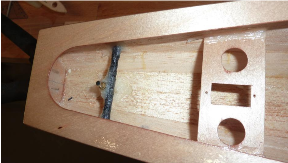
Bild 32: Einbau Ruderservo
