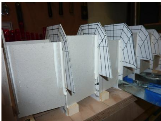
Bild 5 und 6: Das fertige aufgestellte Spantgerüst auf der Helling.
