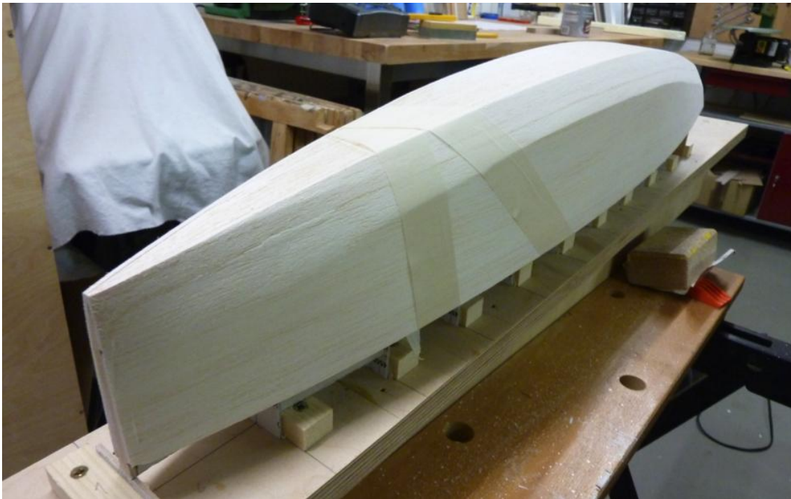
Bild 17: Rumpf mit noch nicht beschnittener Deckschante.
