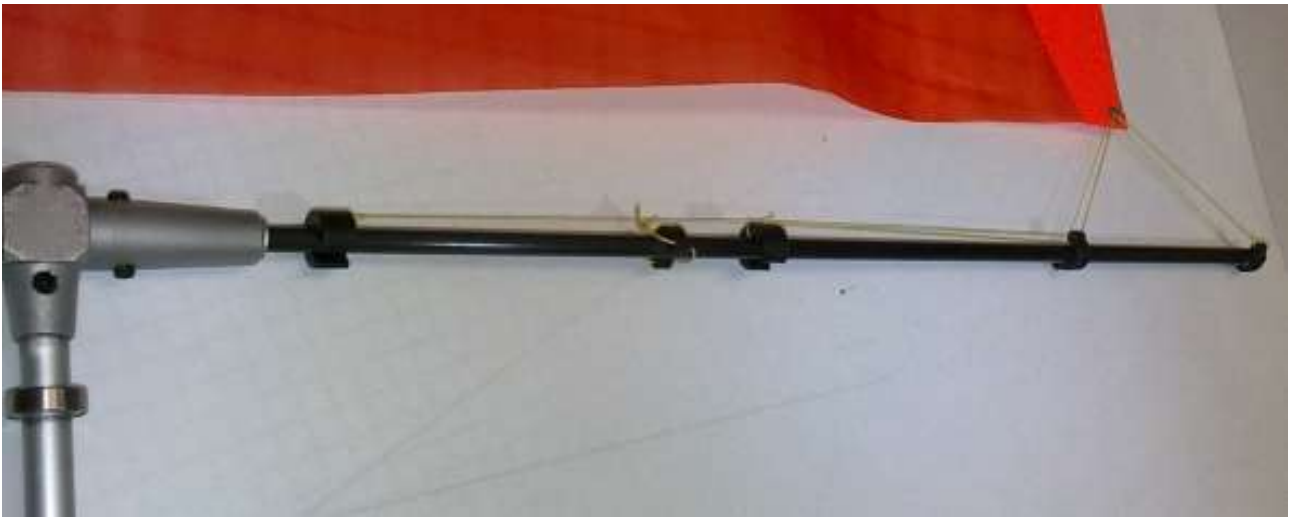
der Großbaum im Detail mit seinen 4 mm Exel - und Graupner Klemmschiebern, der Klemmschieber ganz am Achterliek ist festgeklebt!
