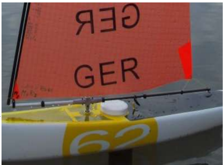
Großbaum z.Teil aus 6 mm Alurohr und 4 mm Cfk Rohr
